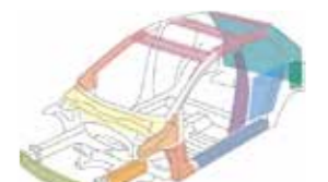
金型でプレス成形される 自動車の骨格部
