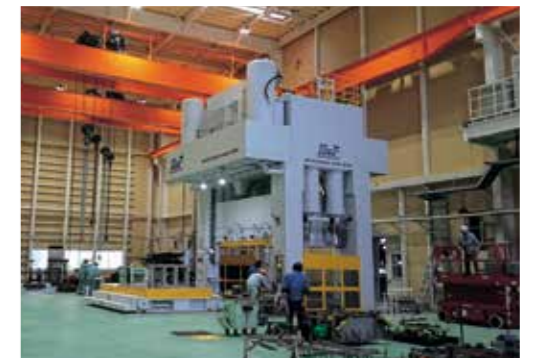
三重工場に設置した1,500トプレス機
